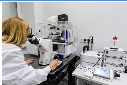
Rys. 2 Laserowy skaningowy system LSM 700 z mikroskopem konfokalnym Zeiss Axio Observer Z1
