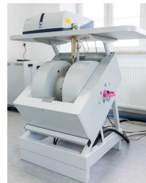
Rys. 4. Spektrometr elektronowego rezonansu paramagnetycznego, typ: EMXplus na pasmo X firmy Bruker.
