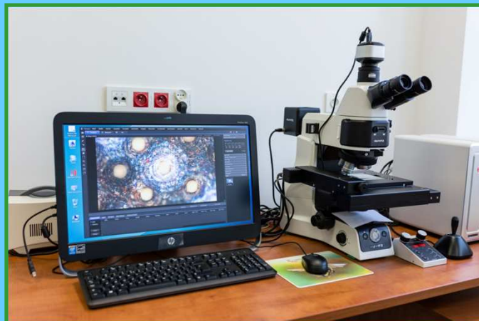
Mikroskop optyczny transmisyjno-odbiciowy
