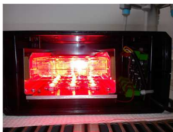
Rycina 1. Oświetlacze LED do napromieniowywania komórek hMSC opracowane w IOE WAT.
