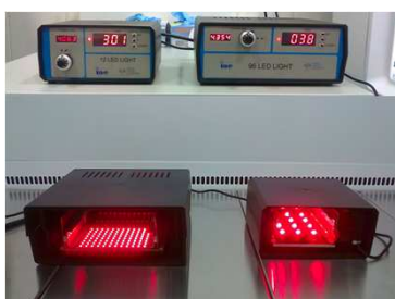
Rycina 1. Oświetlacze LED do napromieniowywania komórek hMSC opracowane w IOE WAT.
